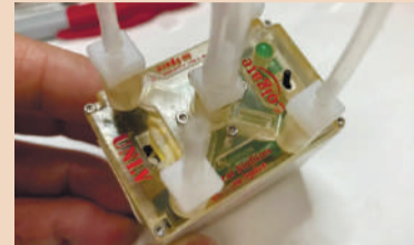
Многоканальная микроструйная помпа, разработанная исследователями из Университета Невады в Лас-Вегасе. (Иллюстрация: Shengjie Zhai/Университет Невады, Лас-Вегас)
