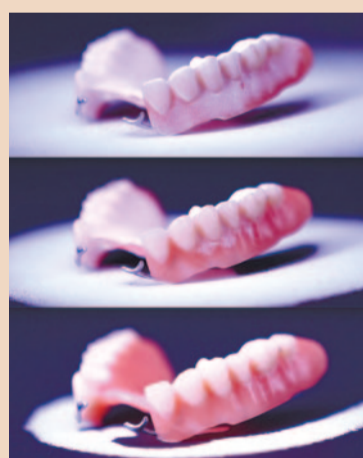
При распылении спрея для трехмерного сканирования на поверхности предмета образуется однородное матовое покрытие белого цвета. Оно устраняет блики, тени и отсветы, мешающие точному сканированию. (Иллюстрация: SCANTIST 3D)
