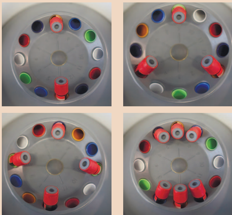
Рис. 2. Принцип уравновешивания центрифуги при загрузке в нее 2, 3, 4 и 6 пробирок. Центрифугирование 5, 7, 9 или 11 пробирок не допускается, следует добавить к ним еще одну, заполненную физраствором пробирку
